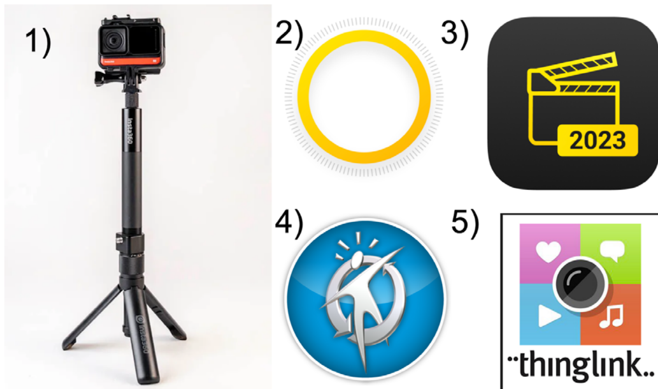
Obr. 6. Zařízení pro vytvoření 360° prohlídky: 1) Insta360 ONE R na stativu; 2) mobilní aplikace Insta360 pro pořizování 360° fotografií; 3) software Insta360 Studio, který přenáší 360° fotografie do počítače; 4) 3D Vista profesionální software pro tvorbu 360° prohlídek; 5) ThingLink bezplatný software pro vytvoření 360° prohlídek
